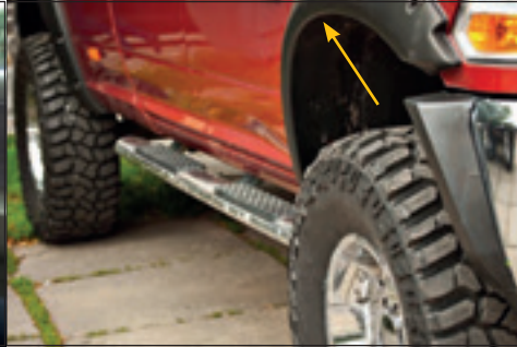
Wielen mogen niet meer dan drie centimeter uitsteken buiten de wielkasten (wielkast is aangegeven met een pijl)
